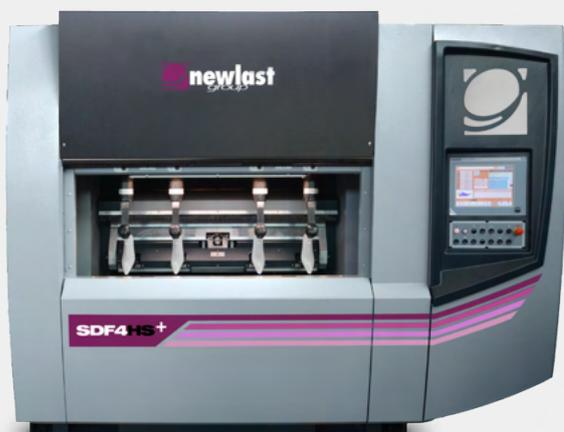
SDF4 HS+ è la finitrice a due paia di ultima generazione. L'innovativo sistema di presa a "coda di rondine" sulla cresta della forma, ne consente la lavorazione completa in macchina, anche nella punta e nel tallone, ed elimina tutti i rischi di deformazione del modello dovuti alla pressione di bloccaggio delle contropunte.
